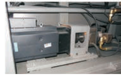
Montaj Sonrası Servo Motor ve İçten Dişli Pompa After Revision
