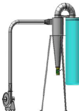
Impianto di aspirazione HS30 o HT40 a bordo macchina.
