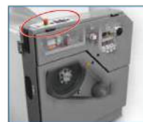
Quadro elettrico integrato. Dispositivi e circuito sicurezze secondo normativa CE.
