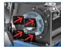
Cuscinetti a sfere applicati alla camera, fissati sulla circonferenza.
